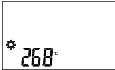
图 5-4 设置温度值显示示意图
