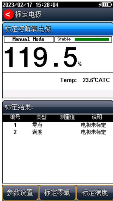
图 5-2 溶解氧标定示意图
